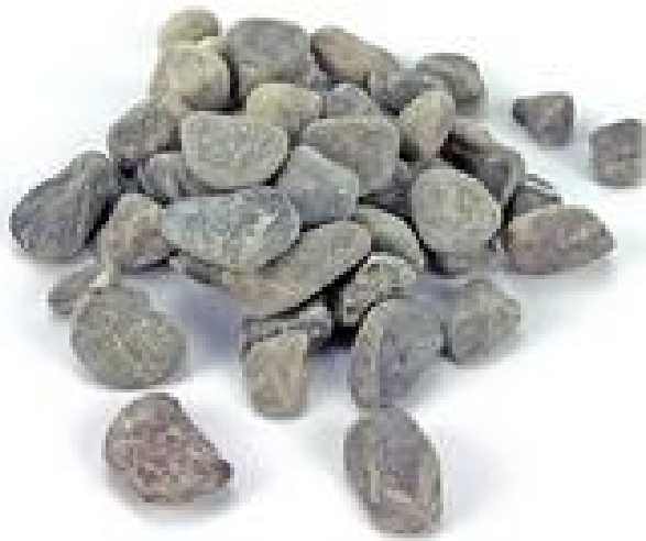
Steine-Kies SAE J400 9,5 mm bis 15,9 mm
